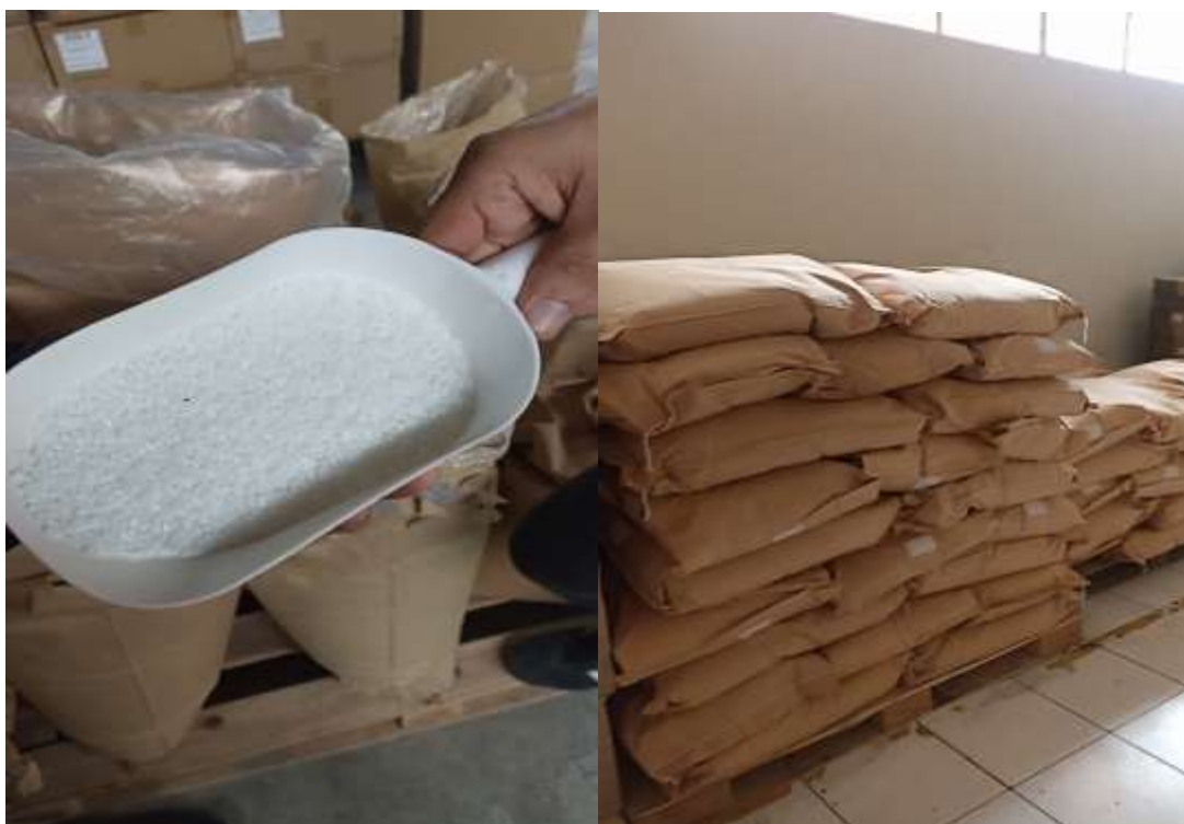
Anexo 1: Materia Prima de Envases Biodegradables, Pellets de ácido poliláctico (PLA)
