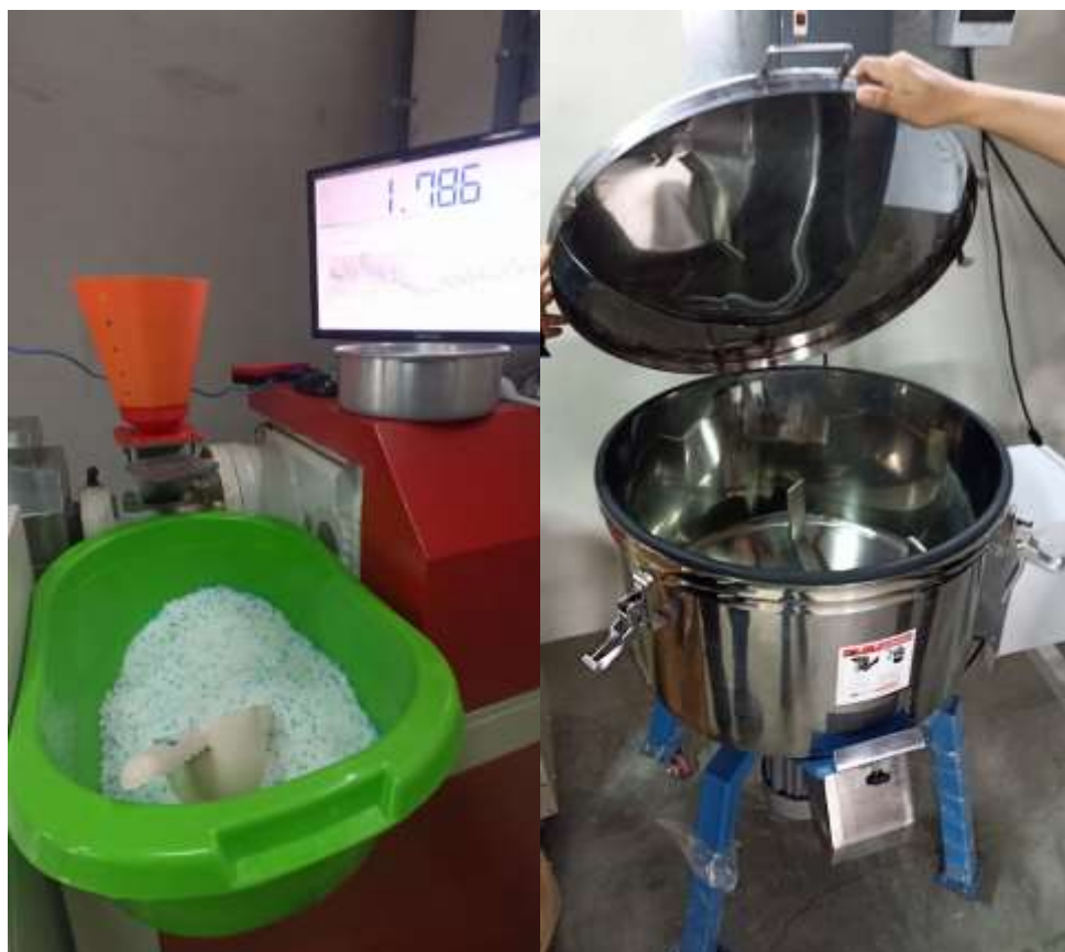
Anexo 5: Homogeneización y secado de los Pellets de Ácido poliláctico.
