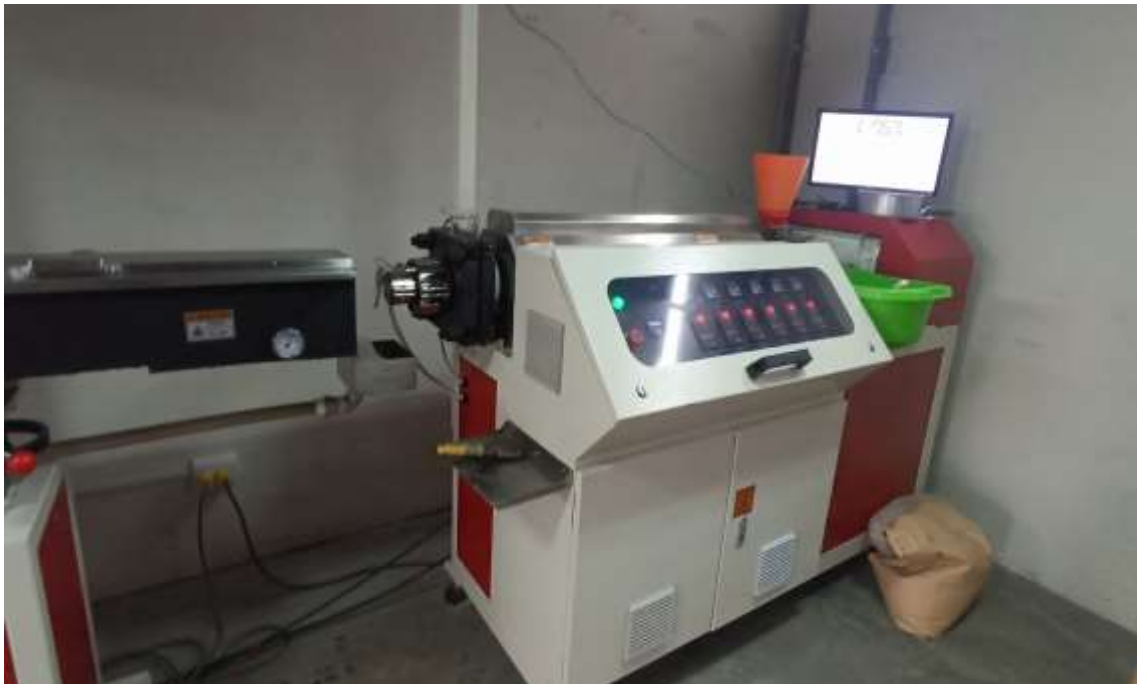
Anexo 6: elaboración de filamento para impresión 3d a base de Acido poliláctico
