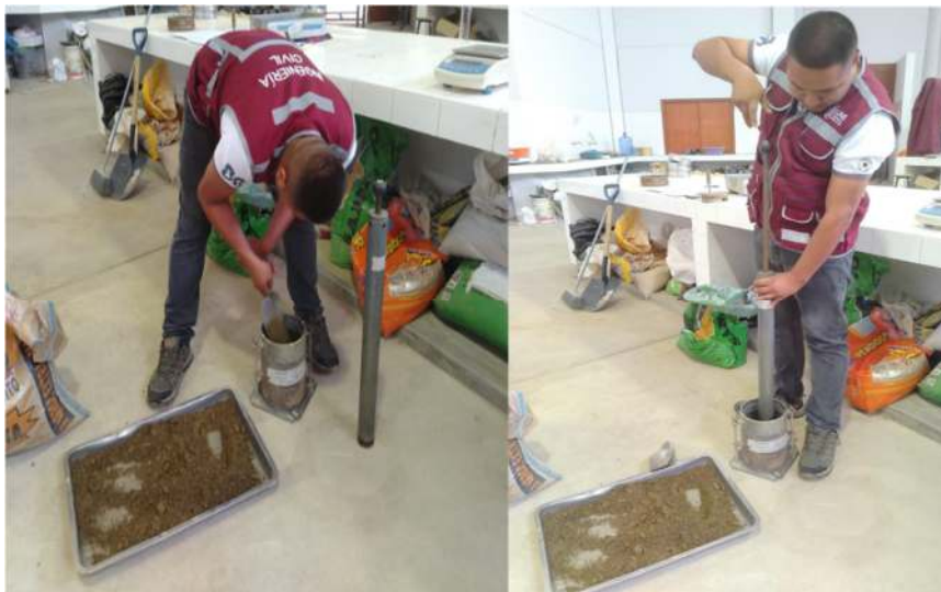
FOTOGRAFIA N°77;78: Compactación con Proctor modificado (Método C) del material granular (cantera Omega)
