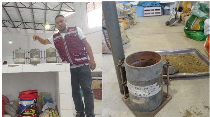
FOTOGRAFIA N°83;84: Compactación de los moldes de CBR antes de humedecer por 4 días.
