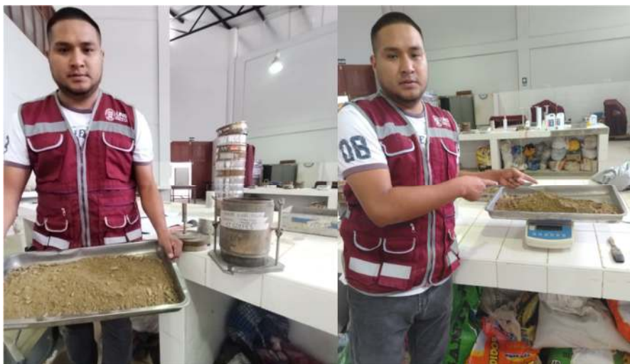
FOTOGRAFIA N°79;80: Muestra de material granular, para su posterior ensayo de Proctor modificado (12, 25 y 56 golpes)
