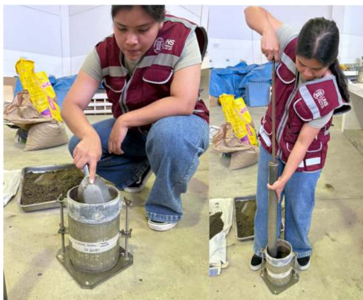
FOTOGRAFIA N°40;41: Compactación de la muestra con su óptimo contenido de humedad, ensayo de CBR. (12, 25 y 56 golpes)
