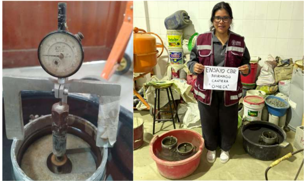
FOTOGRAFIA N°85;86: Colocación del dial, así como la saturación de las muestras para el CBR (Cantera Omega)
