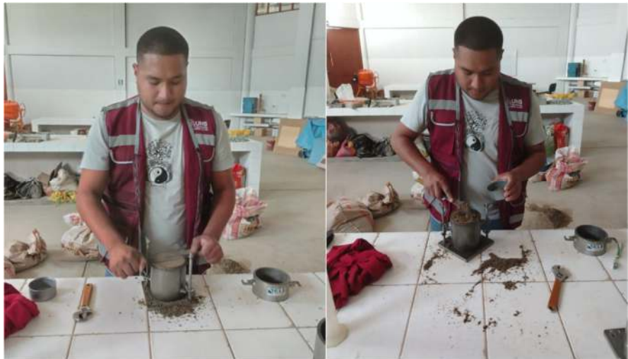
FOTOGRAFIA N°36;37: Enrasado, pesado de la muestra compactada y obtención de muestra representativa para determinar el óptimo contenido de humedad.
