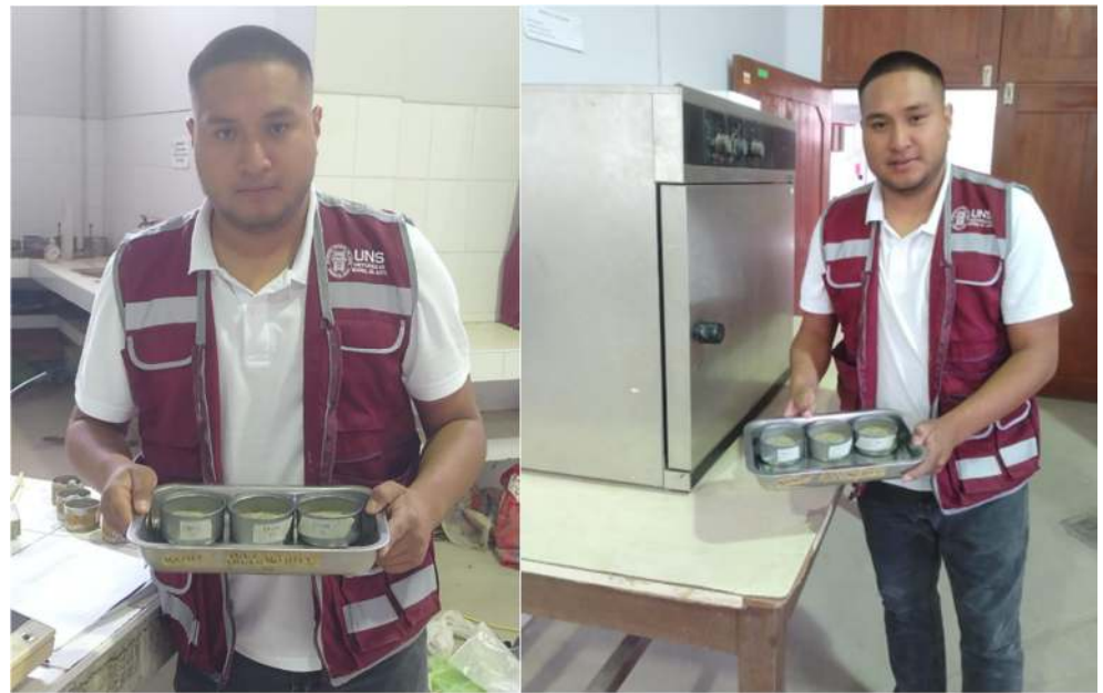
FOTOGRAFIA N°20;21: Determinación del contenido de humedad, peso de la muestra y colocación en el horno.
