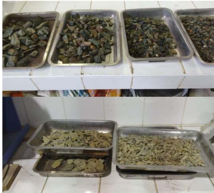
FOTOGRAFIA N°53;54: Lavado de muestras para ensayo correspondiente a la resistencia a la abrasión
