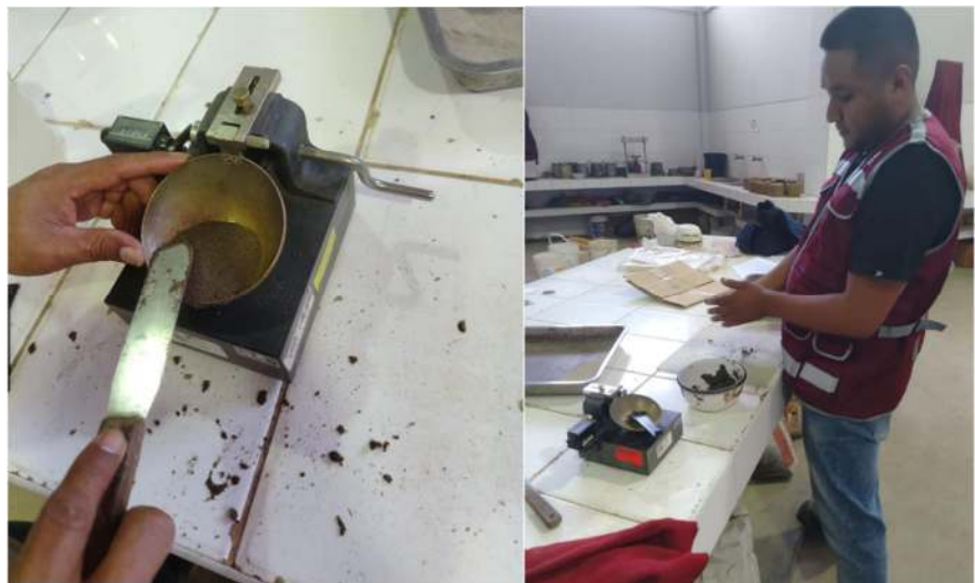
FOTOGRAFIA N°72;73: Determinación del límite líquido a través de la Copa Casagrande (tamiz N°40) del material granular (cantera Omega)
