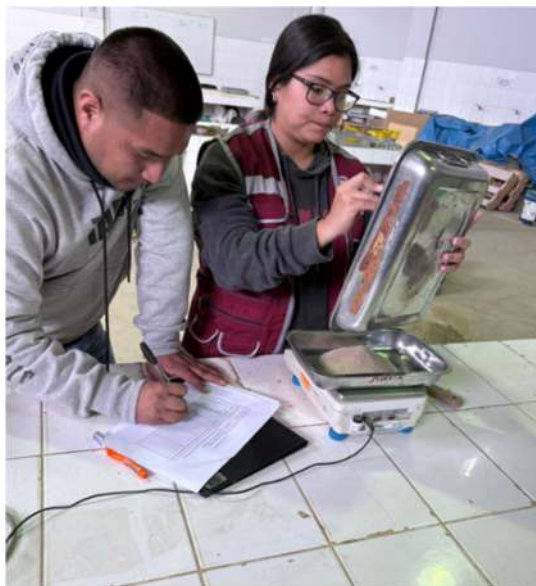
FOTOGRAFIA N°28: Peso de las muestras del ensayo de granulometría, así como las muestras retenidas en cada tamiz.
