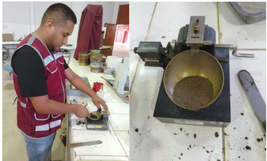
FOTOGRAFIA N°26;27: Determinación del límite líquido a través de la Copa Casagrande (tamiz N°40)
