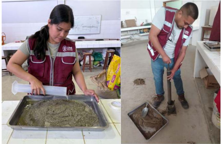
FOTOGRAFIA N°34;35: Humedecimiento para realizar el Proctor modificado (Método A) para 5 muestras
