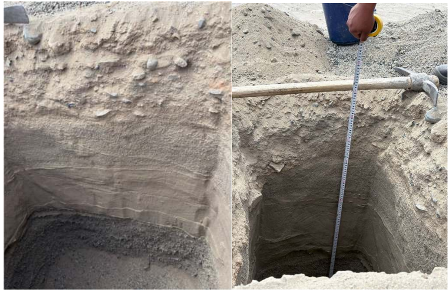
FOTOGRAFIA N°10;11: Profundidad de la calicata (C-02) 1.50m, así como el perfil estratigráfico del suelo.
