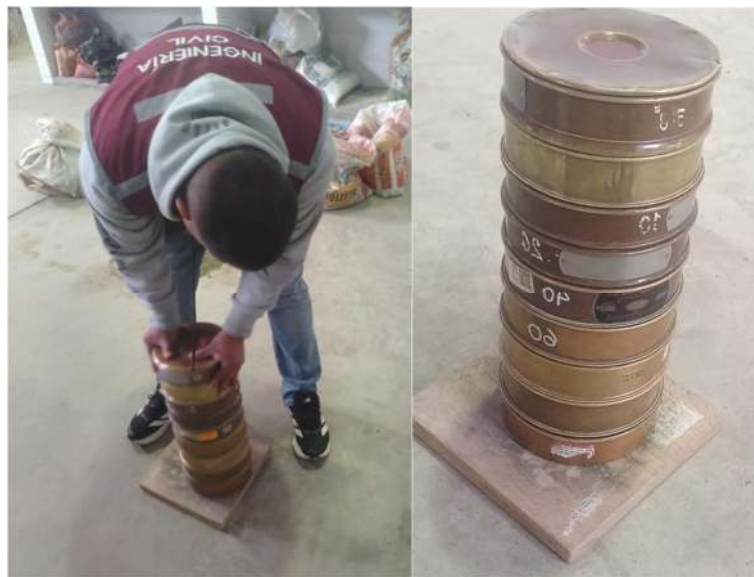
FOTOGRAFIA N°22;23: Tamizado de las muestras para el ensayo de granulometría para material de sub rasante (C-01, C-02, C-03 y C-04)
