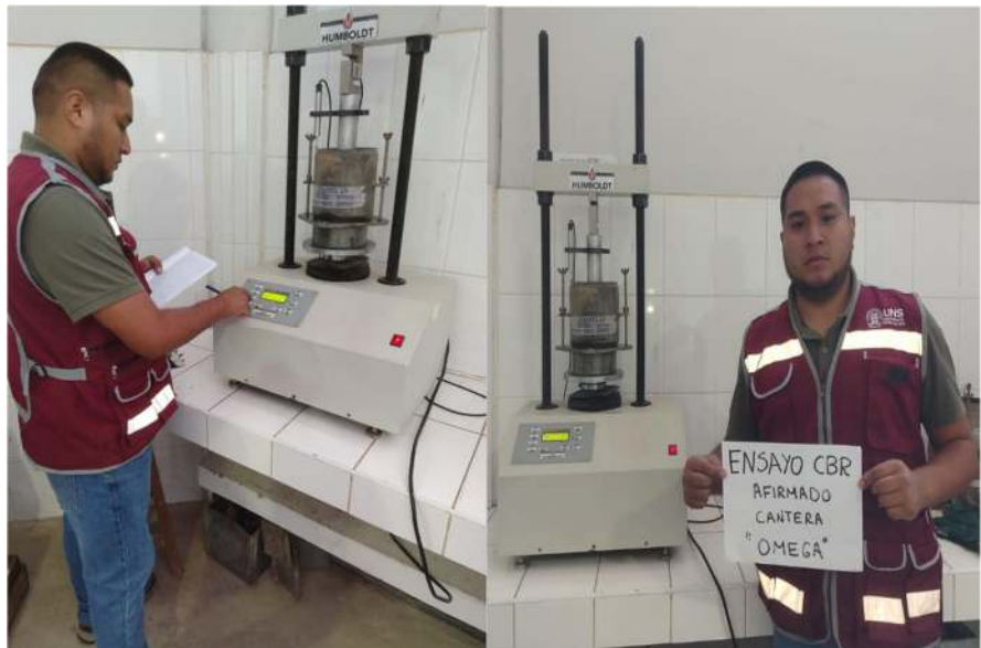
FOTOGRAFIA N°87;88: Ensayo de penetración en la prensa hidráulica de CBR, posterior a las 96 horas de estar sumergido en agua (Cantera Omega)
