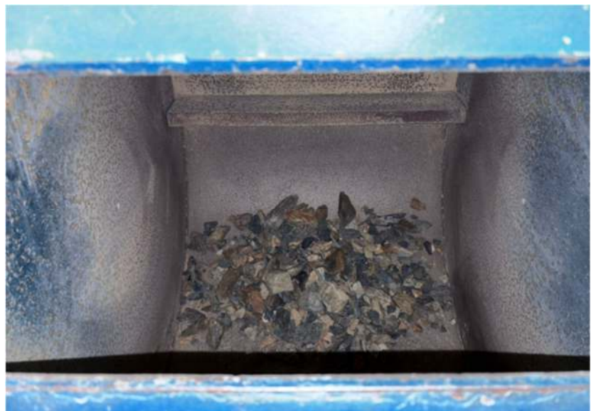
FOTOGRAFIA N°58: Máquina de los ángeles para el ensayo de abrasión y trituración
