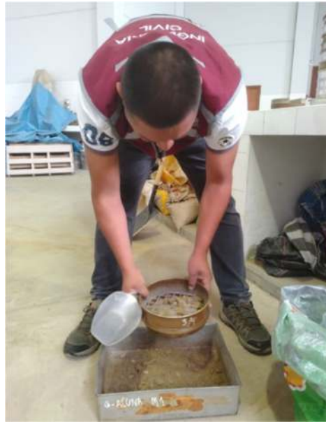
FOTOGRAFIA N°74: Tamizado por la malla \frac{3}{4} " para Proctor modificado (método C).
