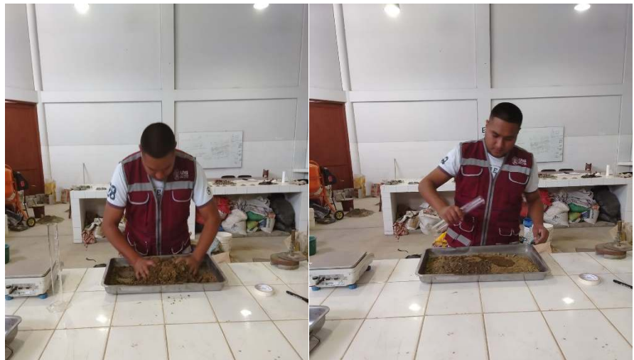
FOTOGRAFIA N°81;82: Preparación de la muestra para CBR, vertiendo su optimo contenido de humedad para todas las muestras (12, 25 y 56 golpes)
