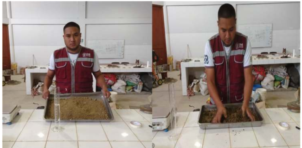
FOTOGRAFIA N°75;76: Humedad de la muestra de material granular, para su posterior ensayo de Proctor modificado (5 muestras).
