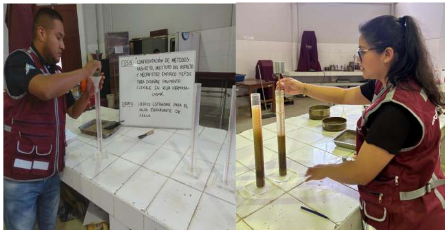
FOTOGRAFIA N°60;61: Ensayo de equivalente de arena para material de cantera Omega
