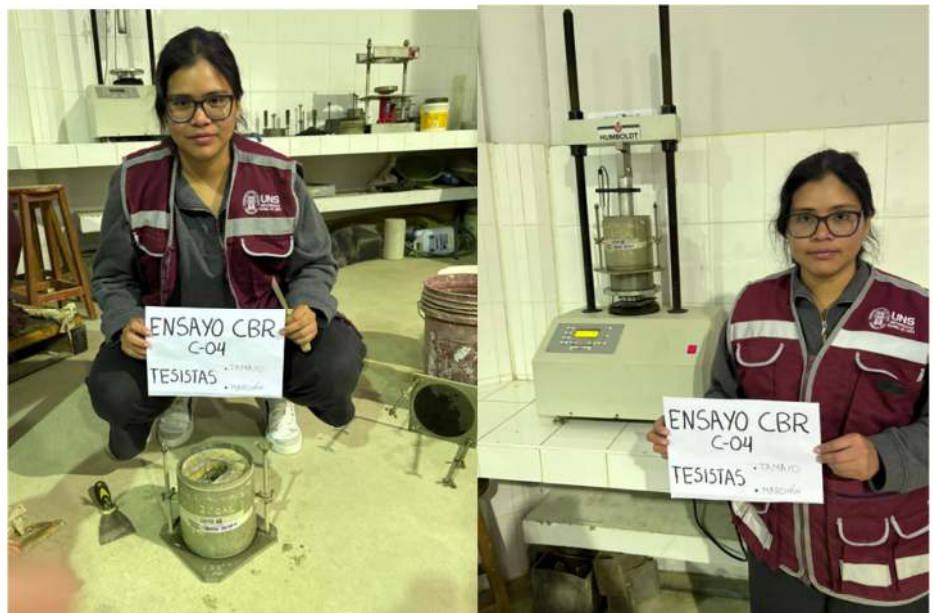
FOTOGRAFIA N°48;49: Ensayo de penetración en la prensa hidráulica de CBR, posterior a las 96 horas de estar sumergido en agua (terreno natural)
