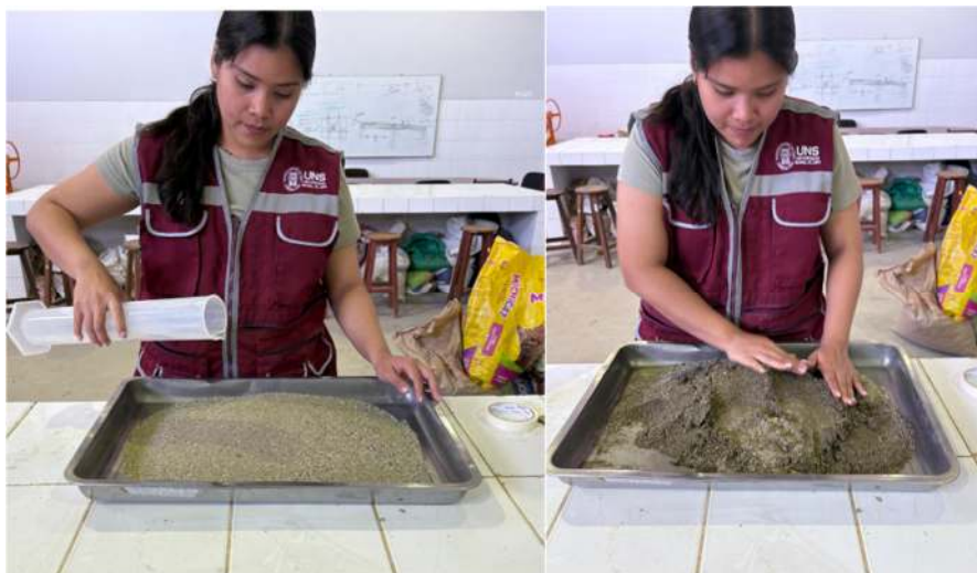
FOTOGRAFIA N°38;39: Preparación de la muestra para CBR, vertiendo su óptimo contenido de humedad.
