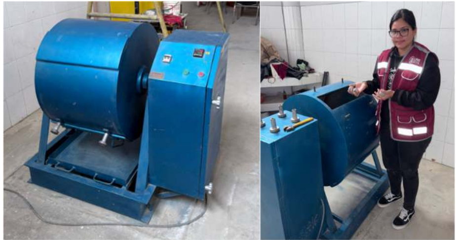
FOTOGRAFIA N°56;57: Máquina de los ángeles para el ensayo de abrasión y colocación de las esferas de acuerdo a norma
