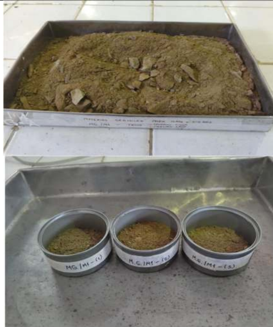
FOTOGRAFIA N°66;67: Muestras para el contenido de humedad del material granular de la cantera “omega”
