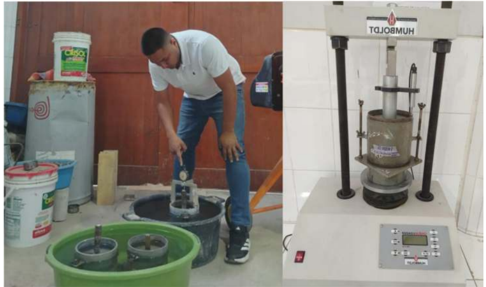
FOTOGRAFIA N°46;47: Colocación del dial, así como la saturación de las muestras para el CBR.
