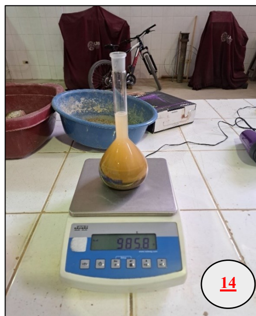
Imagen 13-14: Cono de arena para obtener el peso específico del agregado fino.
