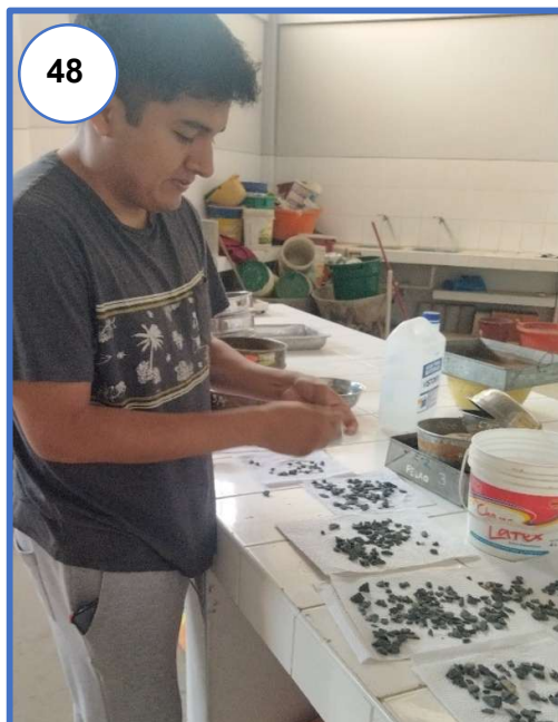
Fotografía N° 48: Para la obtención del peso de la muestra saturada con superficie seca se retira del agua la muestra y se deja secar sobre papel absorbente, mientras se termina de retirar el agua de cada piedra desde el más grande hasta el más pequeño
