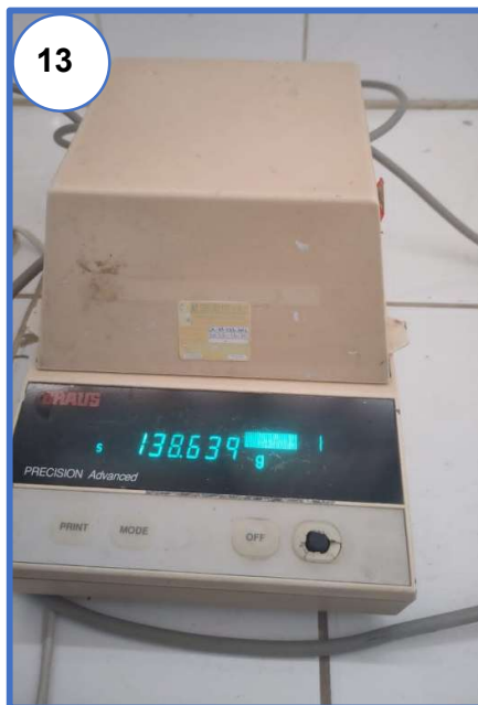
Fotografía N° 12, N° 13 y N° 14: Peso de tara más muestra para el ensayo de contenido de humedad del agregado grueso.
