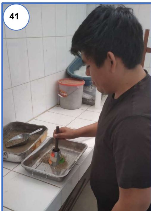
Fotografía N° 41 y N° 42: Colocación de muestra en molde cónico para apisonarlo con 25 golpes de formar uniforme hasta el momento de retirar el molde y la muestra se derrumbe, demostrando que el agregado fino se encuentra saturado superficialmente seco.
