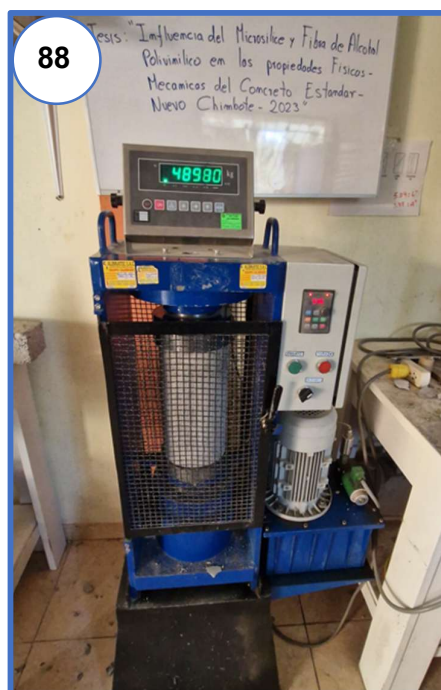
Fotografía N° 88: Rotura de muestra adicionando 1.0 % fibra de PVA y 5.0% de microsíllice a los 28 días.
