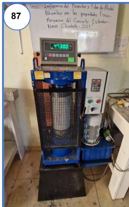
Fotografía N° 87: Rotura de muestra adicionando 0.5% fibra de PVA y 15.0% de microsíllice a los 28 días.
