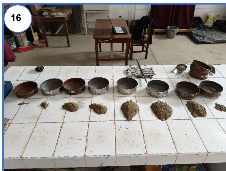
Fotografía N° 15 y N° 16: Tamizado manual para el análisis granulométrico del agregado fino
