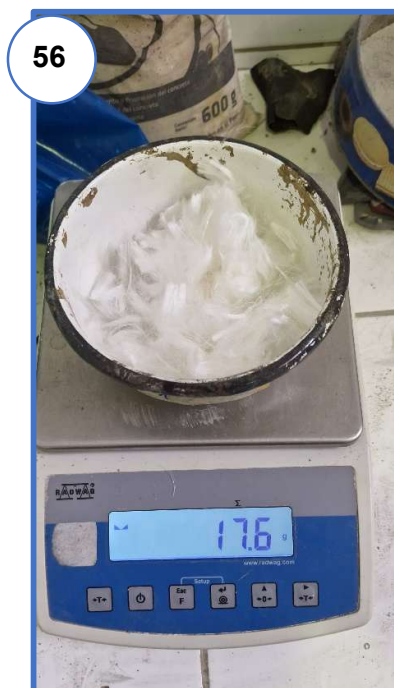
Fotografía N° 53, N° 54, N° 55, N° 56 y N° 57: Materiales para realizar las probetas con la muestra patrón y con los diferentes porcentajes de adición de microsílíce y fibra PVA
