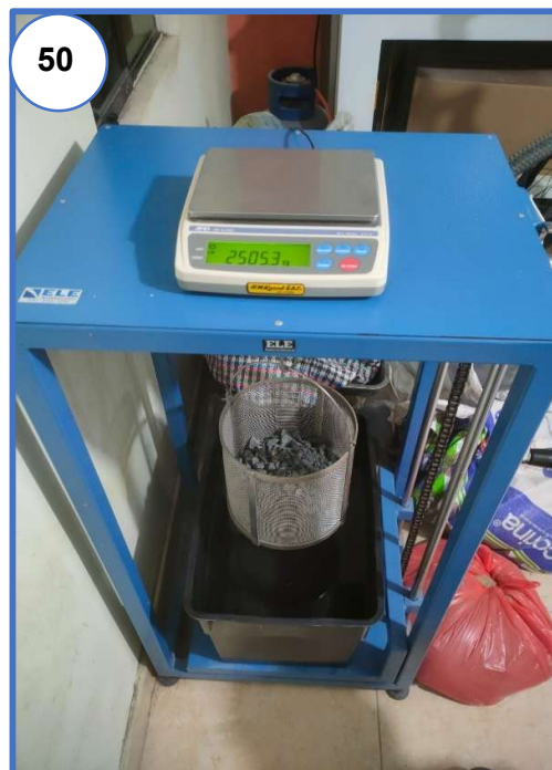
Fotografía N° 49 y N° 50: Tras secar la muestra se coloca en una canastilla y se obtiene su peso sumergido, luego de eso la muestra se seca en el horno durante de dos horas a una temperatura estimada de 100^{\circ}\text{C} \pm 5^{\circ}\text{C} dejándose enfriar alrededor de dos horas, procediendo a pesar dicha muestra
