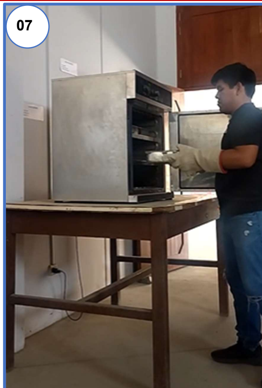
Fotografía N° 07: Colocando la muestra del agregado fino al horno para el ensayo de contenido de humedad
