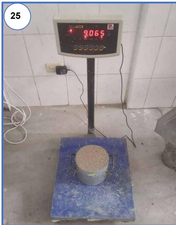
Fotografía N° 22, N° 23, N° 24 y N° 25: Llenado, enrasado, limpieza y pesado del recipiente cilíndrico más muestra para el ensayo del peso unitario suelto del agregado fino.
