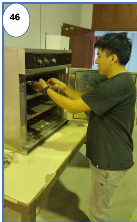
Fotografía N° 46: La muestra se coloca en el horno a temperatura constante de 110 \pm 5^{\circ}\text{C} , , luego a temperatura ambiente se deja enfriar aproximadamente 90 minutos para la obtención de la absorción y de su peso específico.
