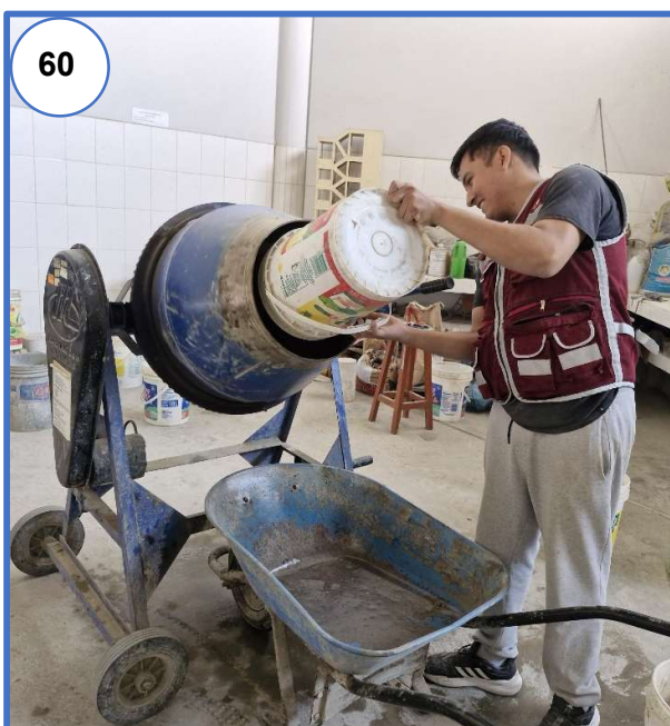
Fotografía N° 59 y N° 60: Se procedió a vaciar los agregados y el agua en conjunto con los aditivos tanto la Fibra PVA y el microsíllice.
