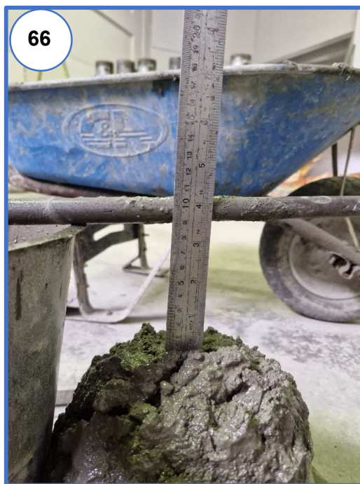
Fotografía N° 66: Se retira el molde hacia arriba y se hace la medición del asentamiento de concreto o "slump"
