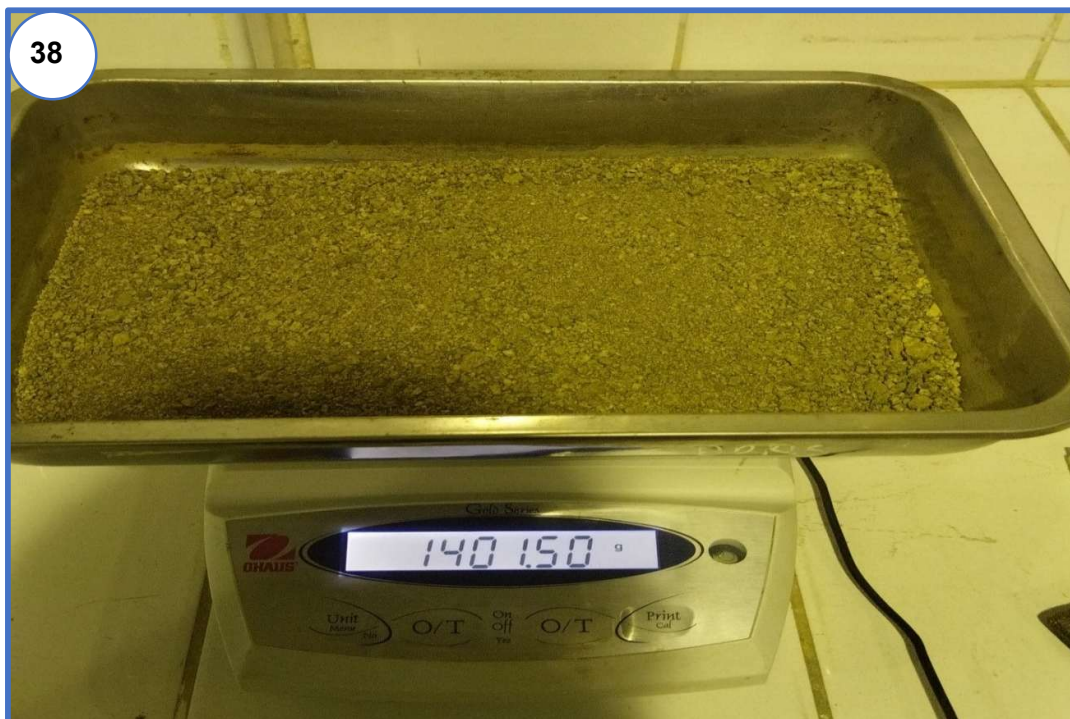
Fotografía N° 38: Muestra para ensayos de peso específico y absorción del agregado fino.
