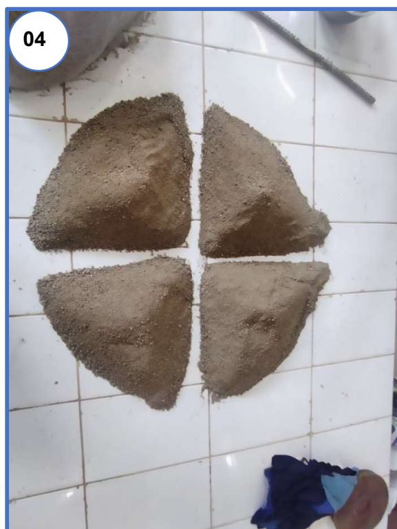
Fotografía N° 03 y N° 04: Se realiza el cuarteo del Agregado Fino
