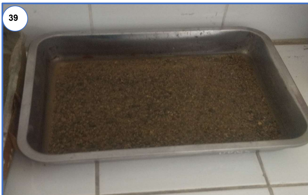
Fotografía N° 39: Recipiente más muestra del agregado fino sumergida en agua durante 24 horas.
