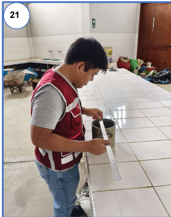
Fotografía N° 20 y N° 21: Mediciones para el cálculo del volumen del recipiente para realizar el ensayo de peso unitario suelto y compactado del agregado fino y agregado grueso.
