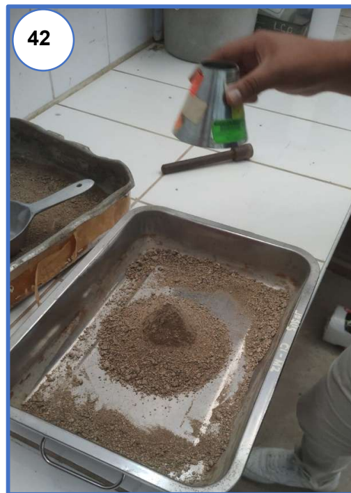
Fotografía N° 41 y N° 42: Colocación de muestra en molde cónico para apisonarlo con 25 golpes de formar uniforme hasta el momento de retirar el molde y la muestra se derrumbe, demostrando que el agregado fino se encuentra saturado superficialmente seco.
