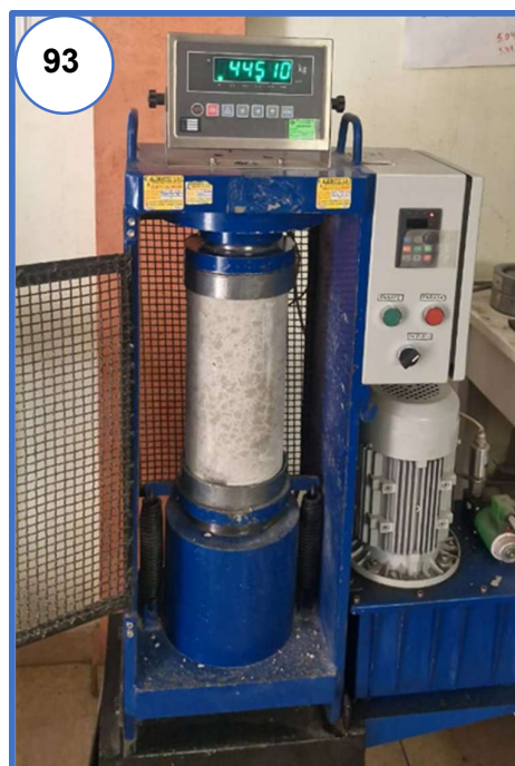
Fotografía N° 93: Rotura de muestra adicionando 1.5% fibra de PVA y 10.0% de microsílíce a los 28 días.
