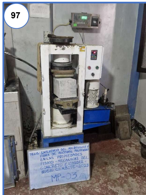
Fotografía N° 95: Rotura de muestra óptima a los 28 días
