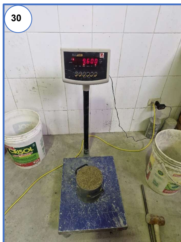
Fotografía N° 26, N° 27, N° 28, N° 29 y N° 30: Llenado, varillado, enrasado, limpieza y pesado del recipiente cilíndrico más muestra para el ensayo del peso unitario compactado del agregado fino.
