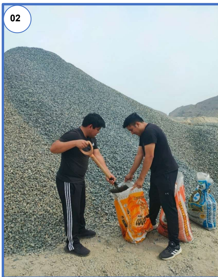
Fotografía N° 02: Extracción de los Agregado de la Cantera “La Sorpresa”
