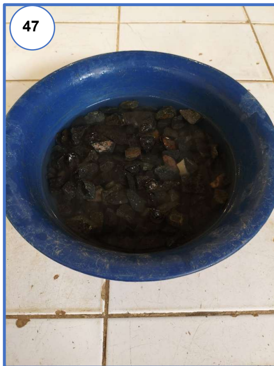
Fotografía N° 47: Recipiente con la muestra de agregado grueso sumergido durante 24 horas.
