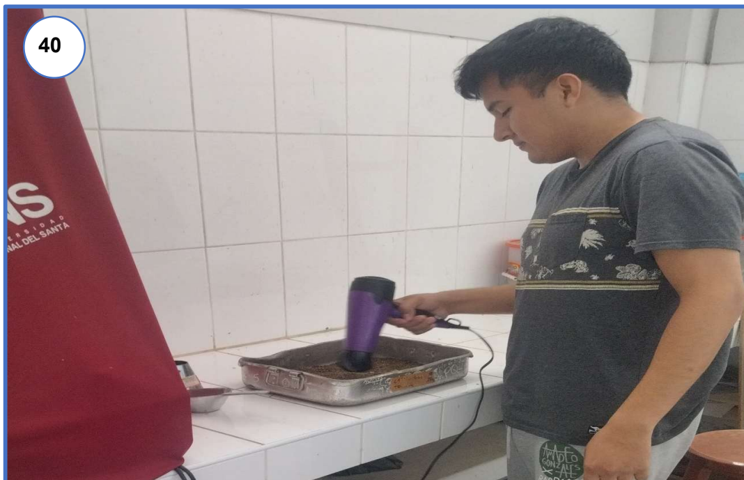
Fotografía N° 40: Secado uniforme del agregado fino mediante aire caliente continuo.
