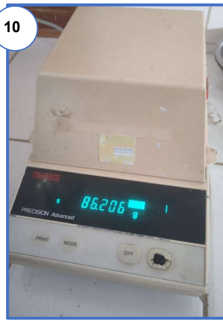
Fotografía N° 08, N° 09 y N° 10: Peso de tara más muestra para el ensayo de contenido de humedad del agregado fino.
