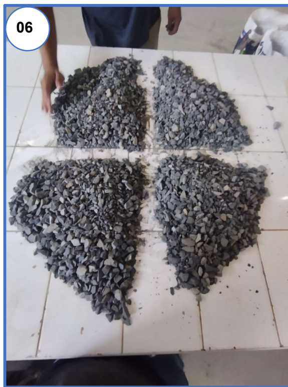
Fotografía N° 05 y N° 06: Se realiza el cuarteo del Agregado Grueso
