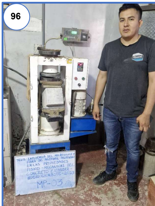
Fotografía N° 95: Rotura de muestra óptima a los 28 días
