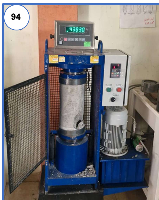
Fotografía N° 94: Rotura de muestra adicionando 1.5% fibra de PVA y 15.0% de microsílíce a los 28 días.
