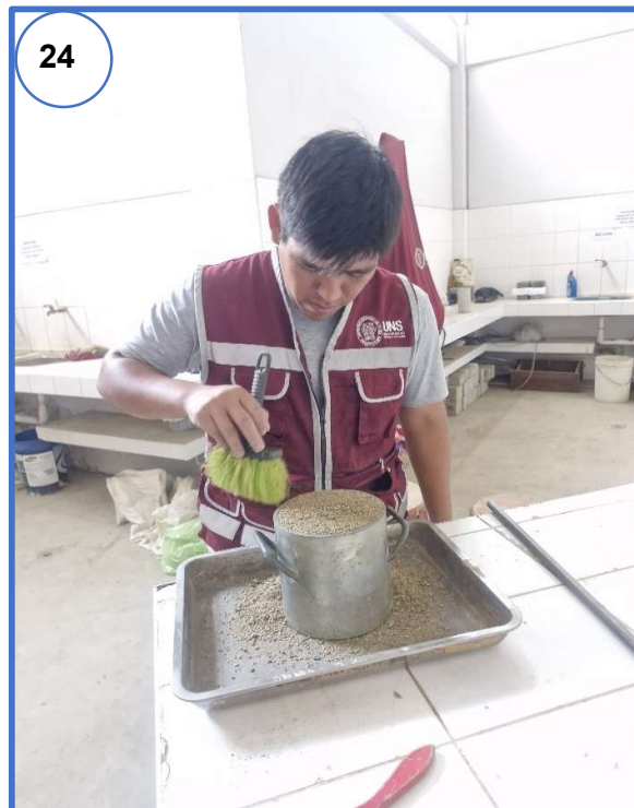
Fotografía N° 22, N° 23, N° 24 y N° 25: Llenado, enrasado, limpieza y pesado del recipiente cilíndrico más muestra para el ensayo del peso unitario suelto del agregado fino.
