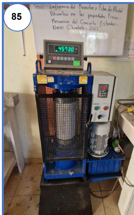
Fotografía N° 85: Rotura de muestra adicionando 0.5% fibra de PVA y 5.0% de microsilíce a los 28 días.
