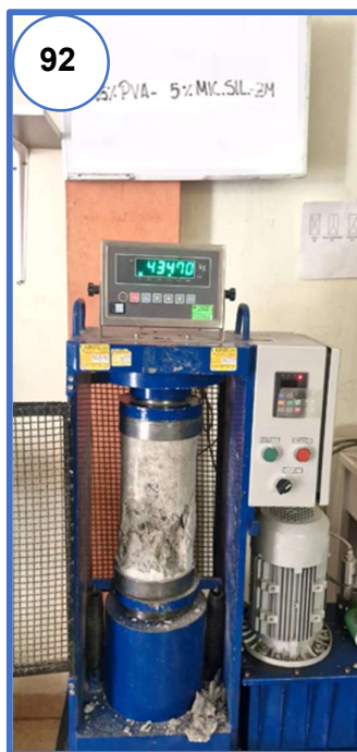
Fotografía N° 92: Rotura de muestra adicionando 1.5% fibra de PVA y 5.0% de microsilíce a los 28 días.
