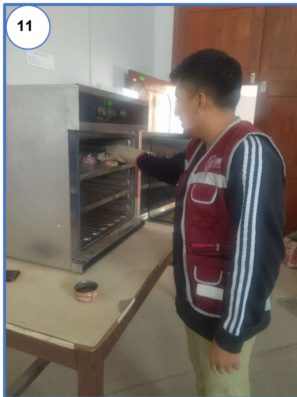
Fotografía N° 11: Colocando la muestra del agregado grueso al horno para el ensayo de contenido de humedad
