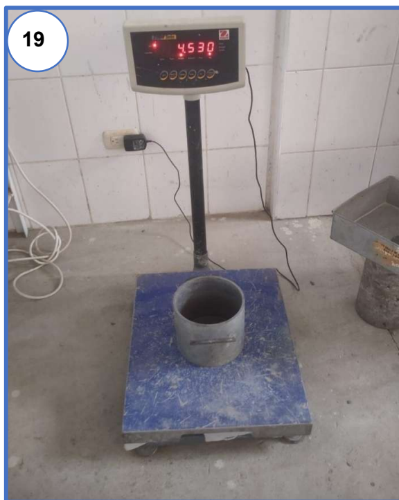
Fotografía N° 19: Pesado del recipiente para realizar el ensayo de peso unitario suelto y compactado del agregado fino y agregado grueso.
