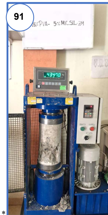
Fotografía N° 91: Rotura de muestra adicionando 1.0 % fibra de PVA y 15.0% de microsilíce a los 28 días.
