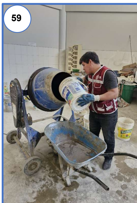
Fotografía N° 59 y N° 60: Se procedió a vaciar los agregados y el agua en conjunto con los aditivos tanto la Fibra PVA y el microsíllice.
