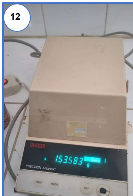
Fotografía N° 12, N° 13 y N° 14: Peso de tara más muestra para el ensayo de contenido de humedad del agregado grueso.
