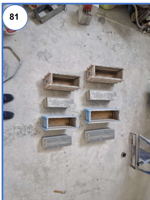
Fotografía N° 81 y N° 82: Después de 24 horas de fraguado se realizó el desencofrado de las probetas prismáticos cuidadosamente para su posterior curado
