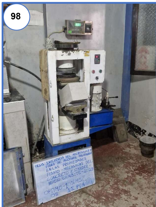
Fotografía N° 98 Y N°99: Rotura de viga prismática del óptimo porcentaje a los 28 días para la resistencia a la flexión.
