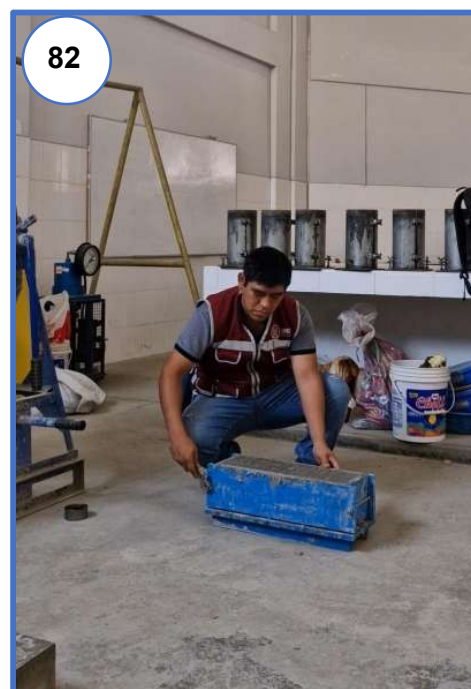
Fotografía N° 81 y N° 82: Después de 24 horas de fraguado se realizó el desencofrado de las probetas prismáticos cuidadosamente para su posterior curado
