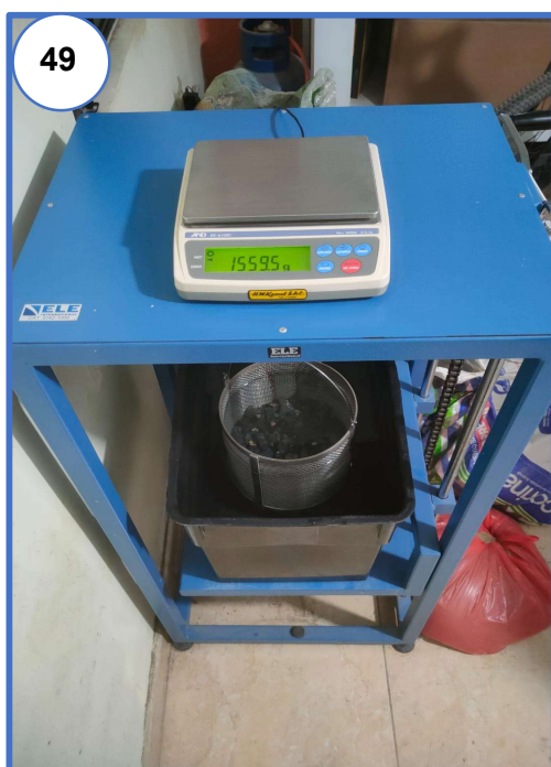
Fotografía N° 49 y N° 50: Tras secar la muestra se coloca en una canastilla y se obtiene su peso sumergido, luego de eso la muestra se seca en el horno durante de dos horas a una temperatura estimada de 100^{\circ}\text{C} \pm 5^{\circ}\text{C} dejándose enfriar alrededor de dos horas, procediendo a pesar dicha muestra
