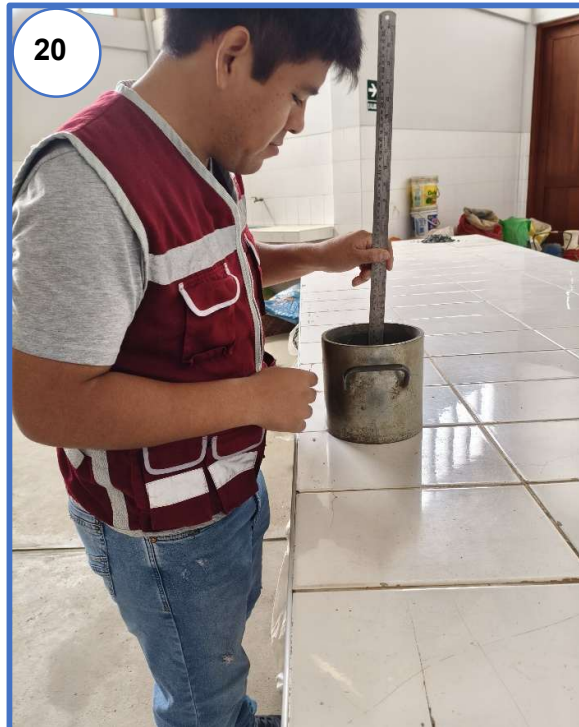
Fotografía N° 20 y N° 21: Mediciones para el cálculo del volumen del recipiente para realizar el ensayo de peso unitario suelto y compactado del agregado fino y agregado grueso.
