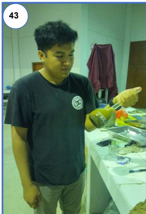
Fotografía N° 43 y N° 44: Muestra del material del agregado fino dentro del frasco volumétrico llenada de agua destilada hasta la marca de enrase y eliminación de burbujas de aire con el uso de cocina eléctrica
