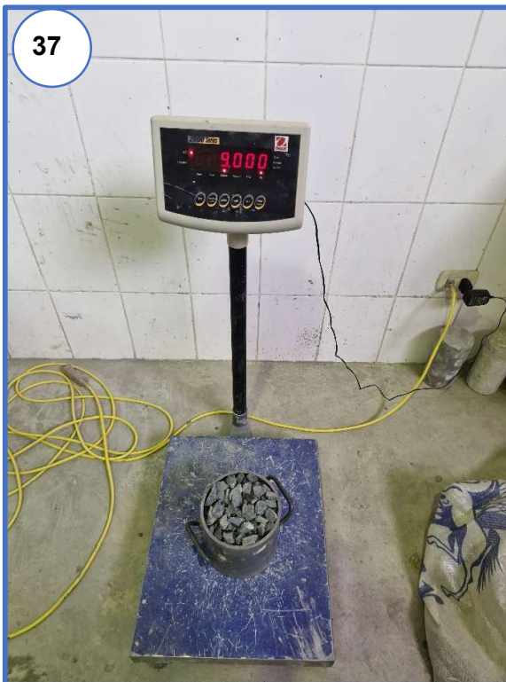
Fotografía N° 34, N° 35, N° 36 y N° 37: Llenado, varillado, enrasado y pesado del recipiente cilíndrico más muestra para el ensayo del peso unitario compactado del agregado grueso.
