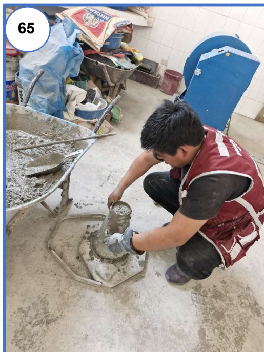
Fotografía N° 64 y N° 65: Se hace el procedimiento para determinar el asentamiento de concreto o "slump" mediante la compactación de 3 capas con 25 golpes de manera uniforme sobre cada una de ellas, utilizamos para dicho procedimiento una varilla lisa de 5/8"
