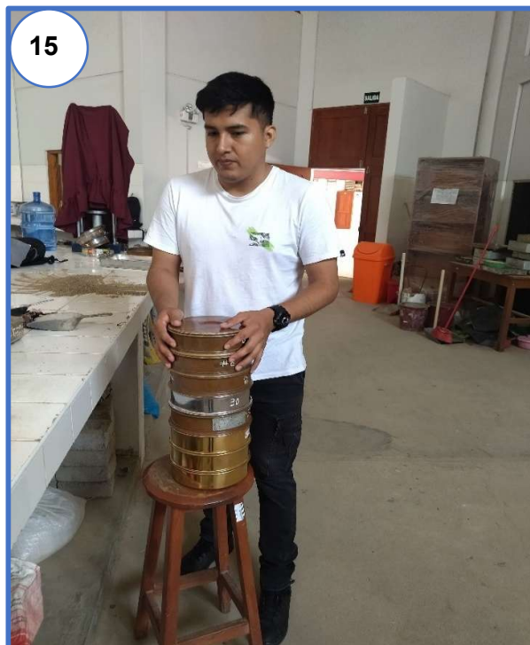
Fotografía N° 15 y N° 16: Tamizado manual para el análisis granulométrico del agregado fino
