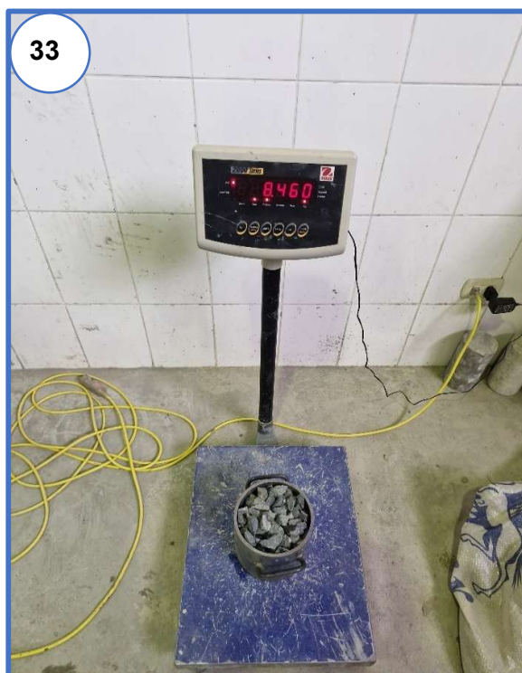
Fotografía N° 31, N° 32 y N° 33: Llenado, enrasado y pesado del recipiente cilíndrico más muestra para el ensayo del peso unitario suelto del agregado grueso.
