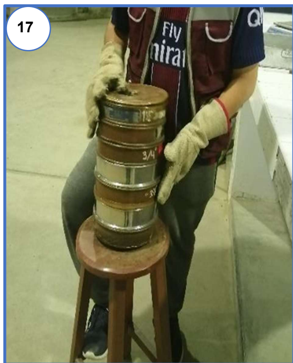
Fotografía N° 17 y N° 18: Tamizado manual para el análisis granulométrico del agregado grueso
