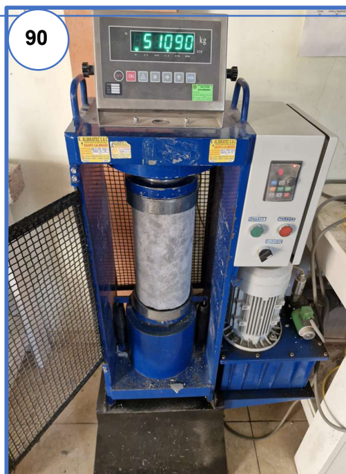
Fotografía N° 89: Rotura de muestra adicionando 1.0 % fibra de PVA y 5.0% de microsílíce a los 28 días.
