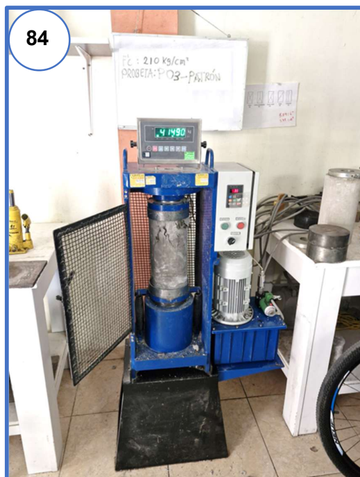
Fotografía N° 84: Rotura de muestra patrón a los 28 días.
