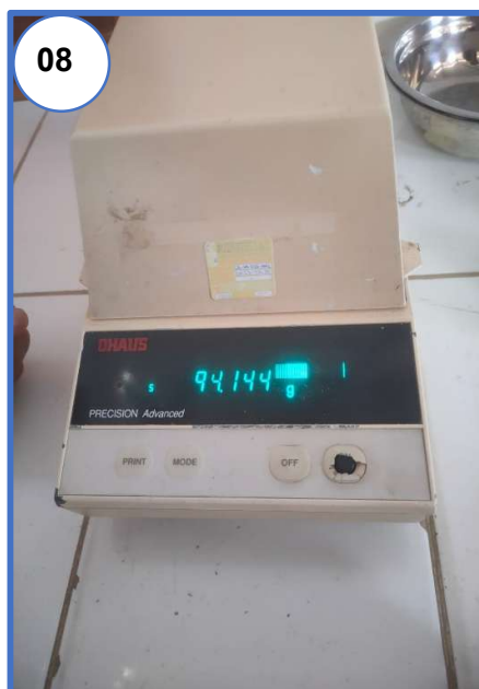
Fotografía N° 08, N° 09 y N° 10: Peso de tara más muestra para el ensayo de contenido de humedad del agregado fino.
