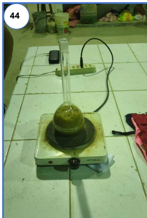
Fotografía N° 43 y N° 44: Muestra del material del agregado fino dentro del frasco volumétrico llenada de agua destilada hasta la marca de enrase y eliminación de burbujas de aire con el uso de cocina eléctrica
