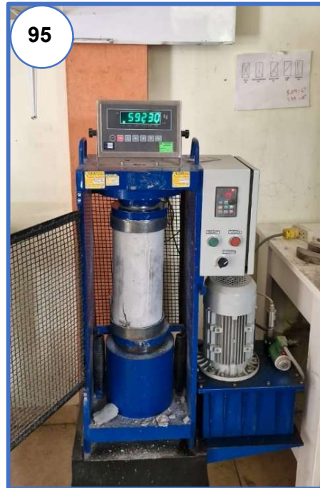
Fotografía N° 95: Rotura de muestra óptima a los 28 días
