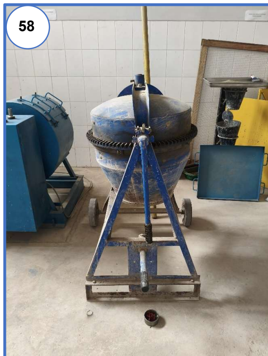
Fotografía N° 58: Mezcladora de concreto tipo trompo para la elaboración de las probetas de concreto
