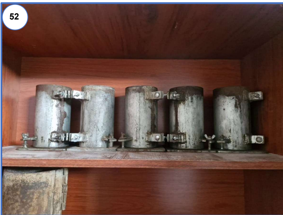
Fotografía N° 51 y N° 52: Moldes cilíndricos de acero para elaboración de probetas.
