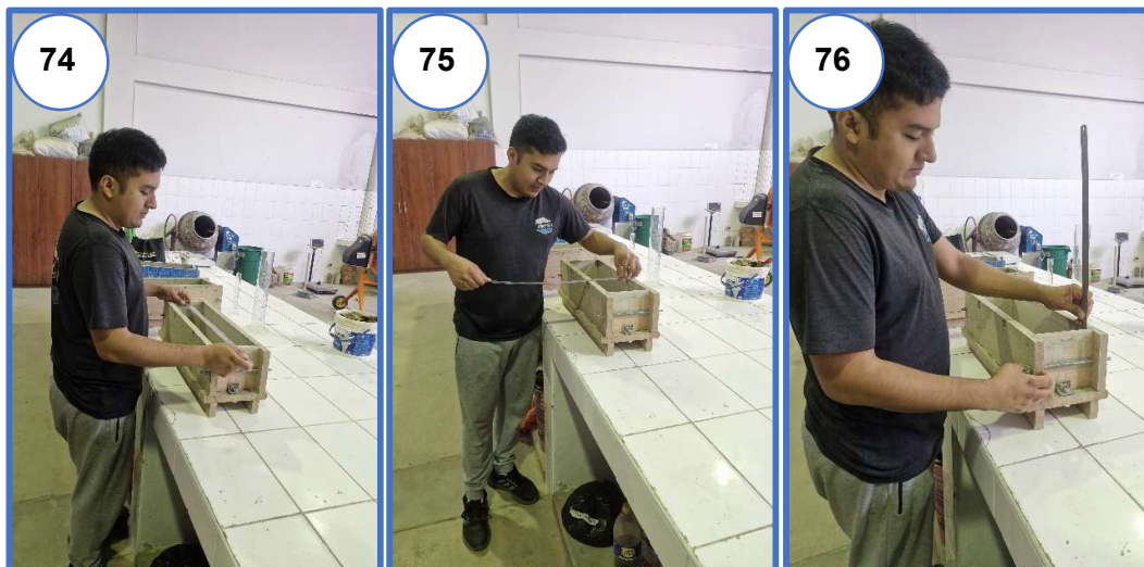
Fotografía N° 74, N° 75 y N° 76: Se midieron las dimensiones del molde prismático
