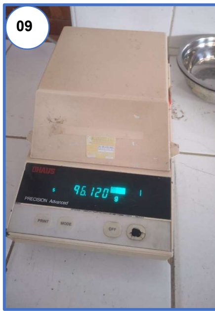
Fotografía N° 08, N° 09 y N° 10: Peso de tara más muestra para el ensayo de contenido de humedad del agregado fino.
