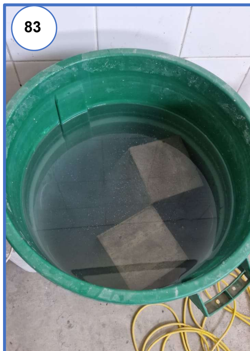
Fotografía N° 83: Curación de las vigas codificadas correctamente para su identificación en los ensayos de flexión.
