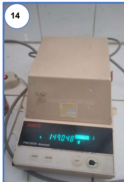
Fotografía N° 12, N° 13 y N° 14: Peso de tara más muestra para el ensayo de contenido de humedad del agregado grueso.
