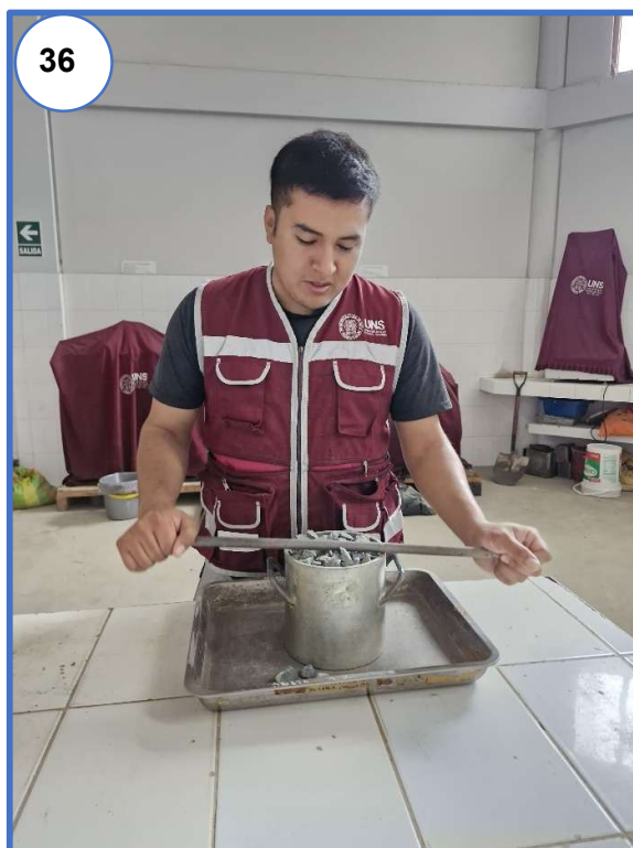
Fotografía N° 34, N° 35, N° 36 y N° 37: Llenado, varillado, enrasado y pesado del recipiente cilíndrico más muestra para el ensayo del peso unitario compactado del agregado grueso.
