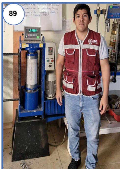
Fotografía N° 89: Rotura de muestra adicionando 1.0 % fibra de PVA y 5.0% de microsílíce a los 28 días.
