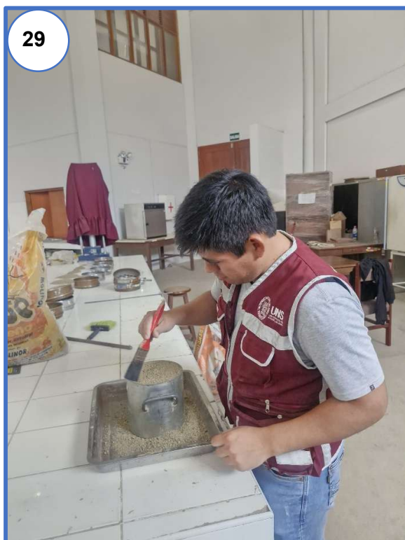
Fotografía N° 26, N° 27, N° 28, N° 29 y N° 30: Llenado, varillado, enrasado, limpieza y pesado del recipiente cilíndrico más muestra para el ensayo del peso unitario compactado del agregado fino.
