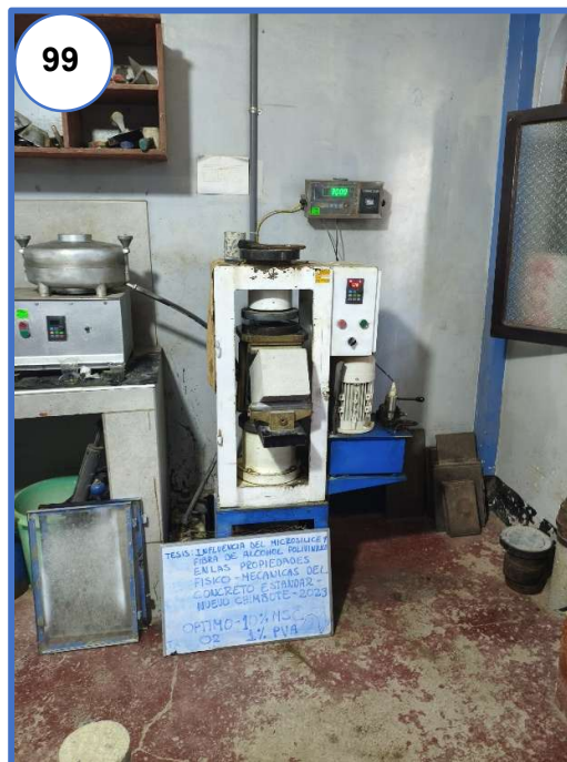
Fotografía N° 98 Y N°99: Rotura de viga prismática del óptimo porcentaje a los 28 días para la resistencia a la flexión.
