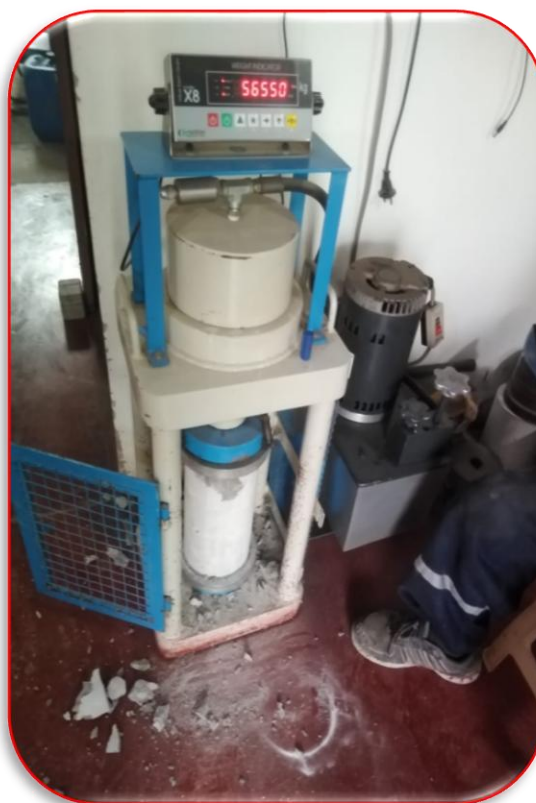
Foto N° 09: Rotura de probeta de concreto con fibra de acero tréfil a la edad de 21 días, para calcular su resistencia a la compresión.
