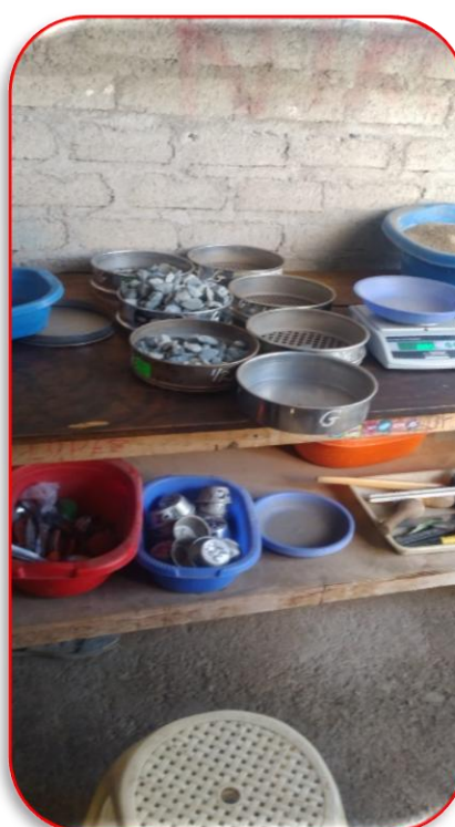
Foto N° 02 y 03: Tamizado de agregado grueso para determinar el tamaño máximo nominal de la piedra.
