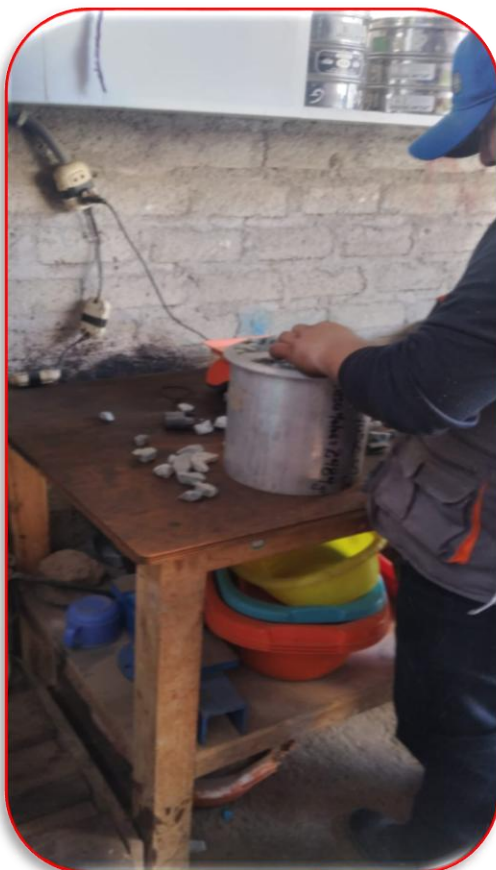
Foto N° 04: Tamizado de Agregado Fino para determinar su modulo de fineza.
