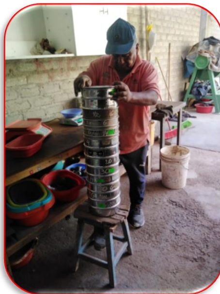
Foto N° 04: Tamizado de Agregado Fino para determinar su modulo de fineza.
