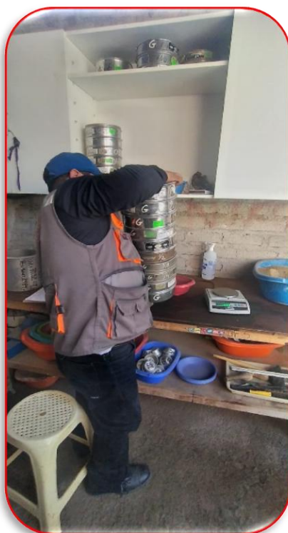
Foto N° 02 y 03: Tamizado de agregado grueso para determinar el tamaño máximo nominal de la piedra.
