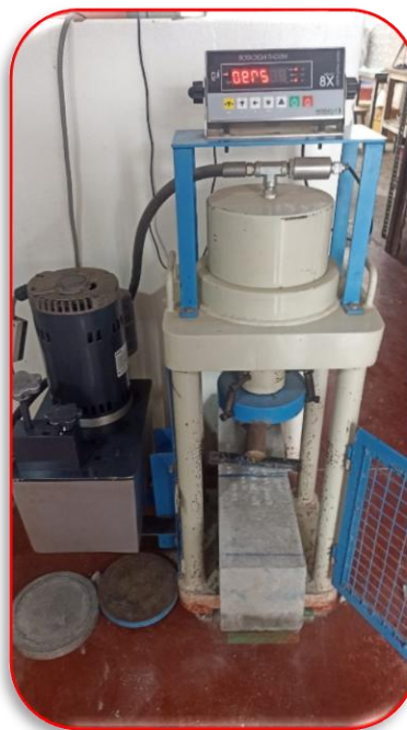
Foto N° 13, 14, 15 y 16: Rotura de vigas de concreto con 2 apoyos en los extremos y una carga aplicada en el centro para determinar su resistencia a la flexión.
