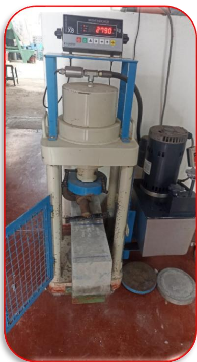
Foto N° 13, 14, 15 y 16: Rotura de vigas de concreto con 2 apoyos en los extremos y una carga aplicada en el centro para determinar su resistencia a la flexión.
