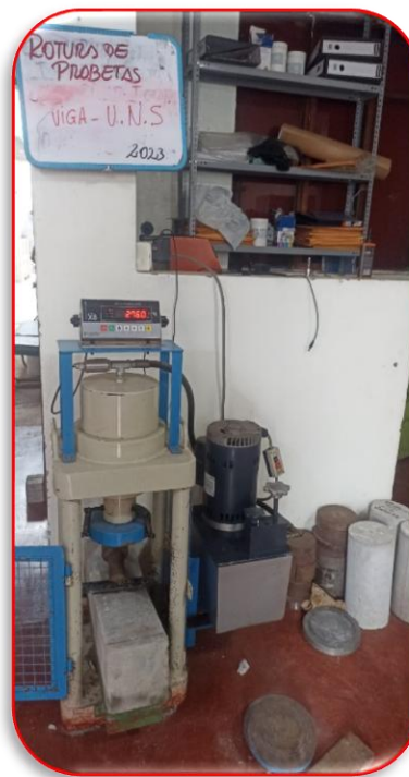
Foto N° 13, 14, 15 y 16: Rotura de vigas de concreto con 2 apoyos en los extremos y una carga aplicada en el centro para determinar su resistencia a la flexión.
