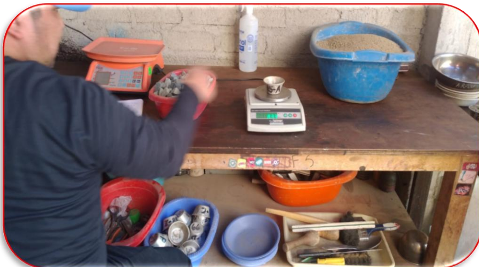
Foto N° 01: Pesaje de muestras para cálculo de contenido de humedad.
