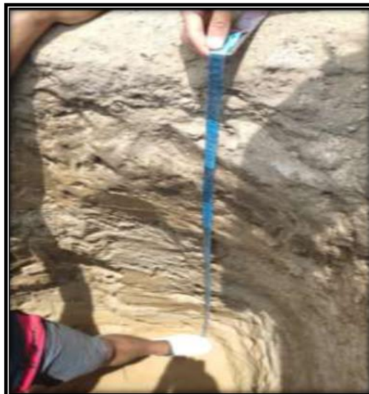
FOTOGRAFÍA 05: Muestra del perfil del suelo obtenido de la calicata excavada a una profundidad de 1.50 m desde el nivel superficial, para su análisis y caracterización geotécnica.
