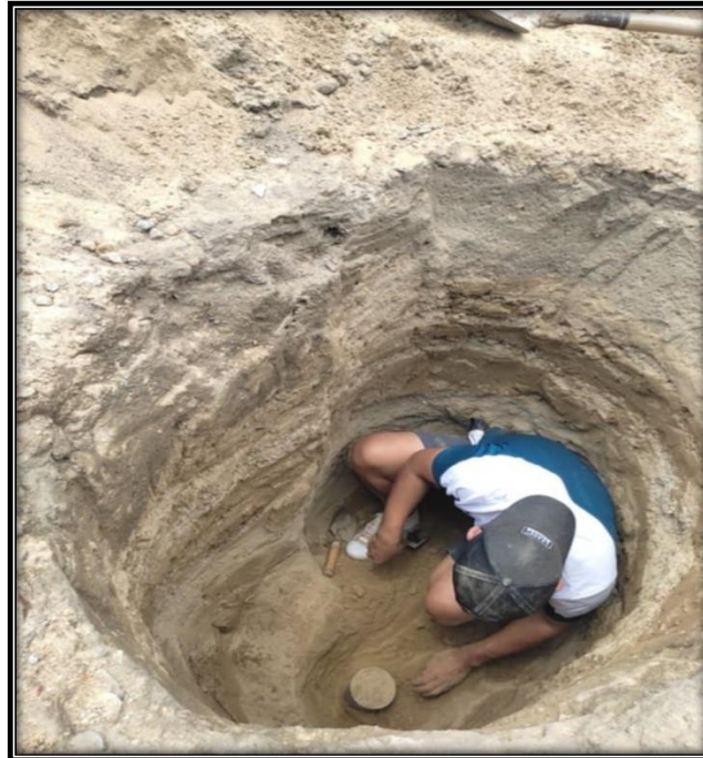
FOTOGRAFÍA 04: La calicata fue excavada hasta una profundidad de 1.50 m desde el nivel superficial del terreno, cumpliendo con los parámetros establecidos para el análisis del perfil del suelo.
