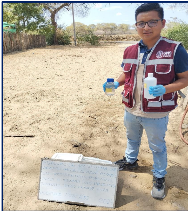
Fotografía 20 Muestreo para el análisis de la calidad del agua
