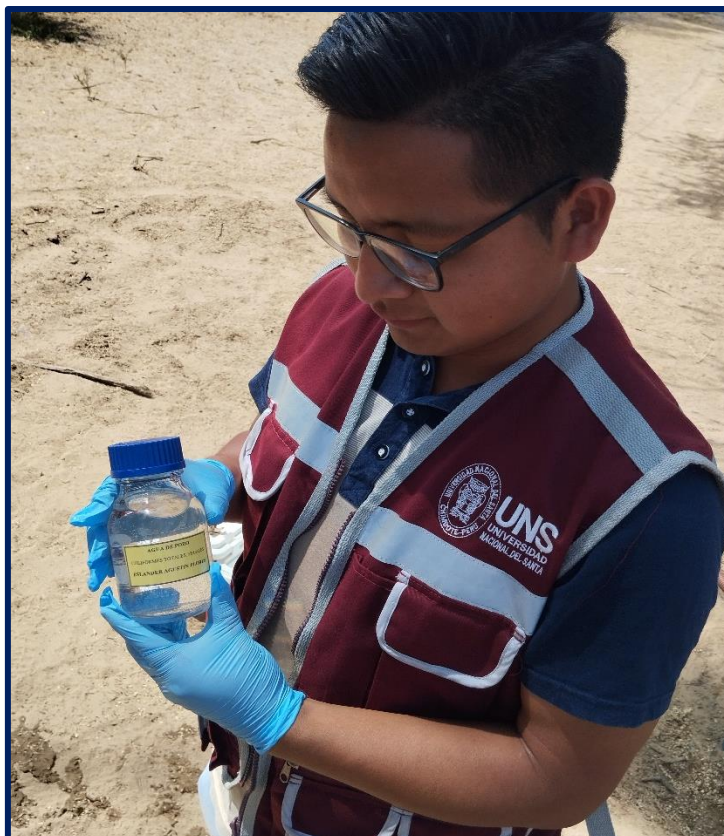
Fotografía 21 Muestra en frasco de vidrio estéril transparente con tapa
