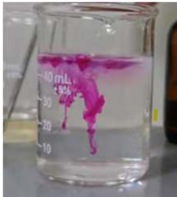
ANEXO 37. Adición de fenolftaleína
