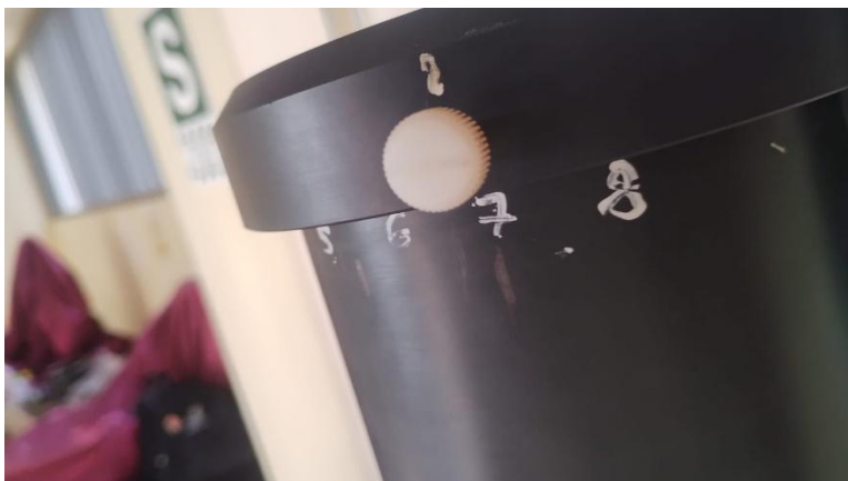
Válvula de estrangulamiento del ventilador.
