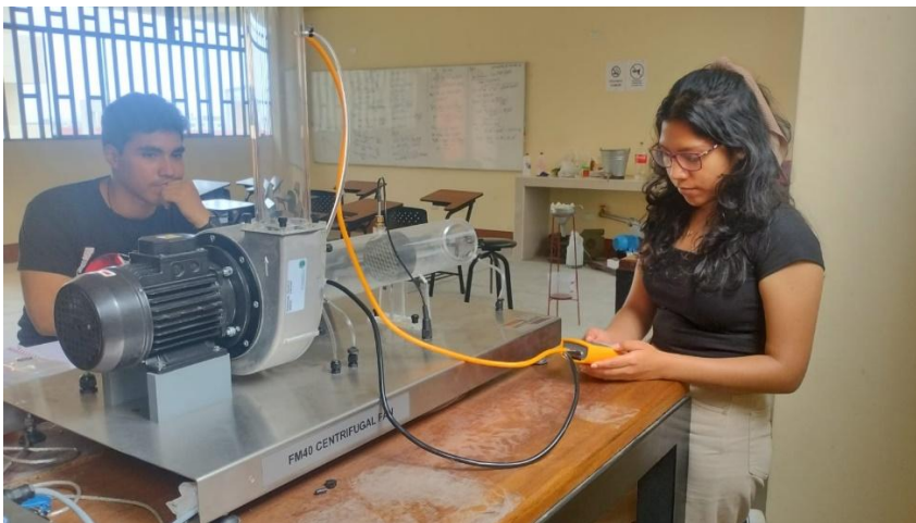
Toma y recolección de datos de las pruebas realizadas con el rotor existente y el rotor diseñado.
