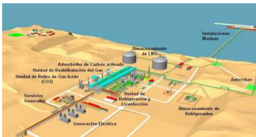
Distribución de áreas de Planta de Licuefacción de Perú GNL
