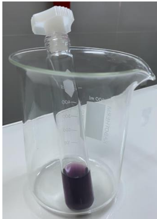
Anexo 61. Preparación de DPPH + Metanol para las muestras
