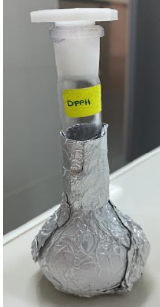
Anexo 58. Solución DPPH aforado con metanol
